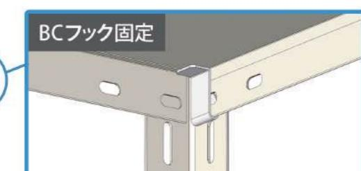
「支柱」の穴に、高さが揃うように1段あたり4つの「BCフック」を引っかけて、上から「棚板」を置きます。ボルト固定とは違い、「棚板」の高さ変更が容易に行えます。
