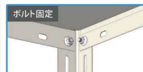
「棚板」が水平になるように、ボルトを本締めする。最上段・最下段と同じように少しづつ増し締めしていくとバランスがとりやすいです。
